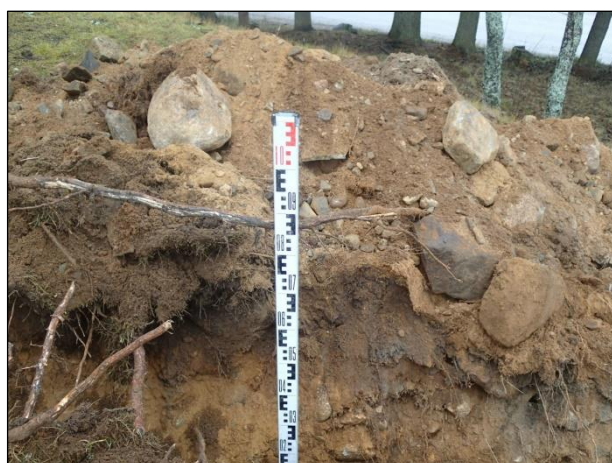
Vasen: Kaapelikaivantoa Letkun koulumäellä. Ohuen turpeen alla on hiekkamoreeni. Oikea: Kaapelikaivantoa Letkun koulumäellä. Alarinteessä ja rinteen juurella savea, ylempänä mäessä hiekkamoreenia. Itään.
